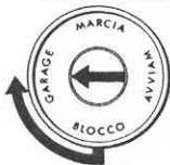
Per lo sbloccaggio dello sterzo ruotare la chiave dalla posizione BLOCCO alla posizione GARAGE (per facilitare tale operazione è consigliabile fare oscillare leggermente il volante nei due sensi).
