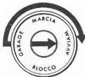
Far ruotare la chiave dalla posizione GARAGE alla posizione MARCIA; si inserisce il contatto elettrico (con accensione della spia alternatore). Far ruotare ancora la chiave fino alla posizione AVVIAM.; si aziona il motorino di avviamento e la chiave, rilasciata, ritorna automaticamente nella posizione MARCIA.
