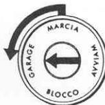
Per arrestare il motore far ruotare la chiave in senso antiorario fino alla posizione GARAGE.
