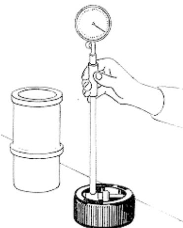
**CALIBRO per azzerare l'alesometro controllo  $\varnothing$  canne cilindri**
